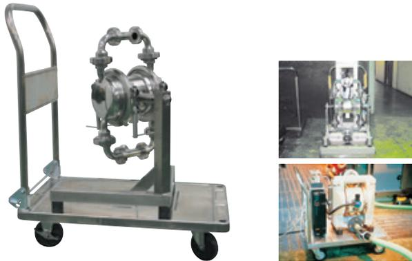
複数ラインでの使い回しやテスト運転、持ち運びに便利な台車タイプ。さらに、ご希望の補器を全てセットしたユニットタイプもご用意しています。
